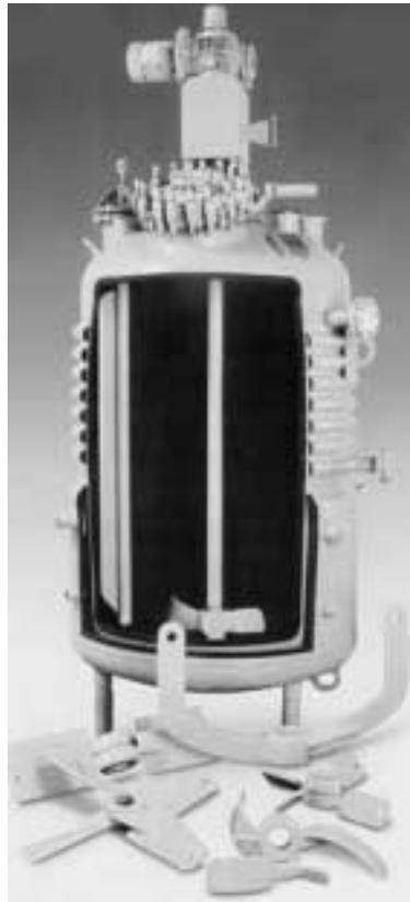
Reactor Tanque Agitado
